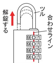
①合わせラインのある面を正面にし、解錠状態にしてツルを持ち上げてください。
