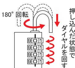
②ツルを180度回転させ、下に強く押し込みながらダイヤルを回して、お好きな番号にあわせます。
